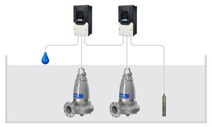
Eine typische SmartRun-Installation: Bei einer Doppelpumpstation ist je Pumpe ein SmartRun erforderlich und je Pumpstation ein Niveauschalter und ein Drucksensor. Fällt eine aktive Einheit aus, so wird die Stand-By-Einheit die Funktion übernehmen.
