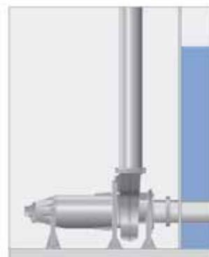
**CZ** - Horizontale, stationäre Trocken- oder Inline-Aufstellung mit Flanschanschlüssen für Saug- und Druckleitung.
