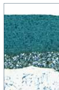
Querschnitt der Flygt-Epoxidharzbeschichtung
